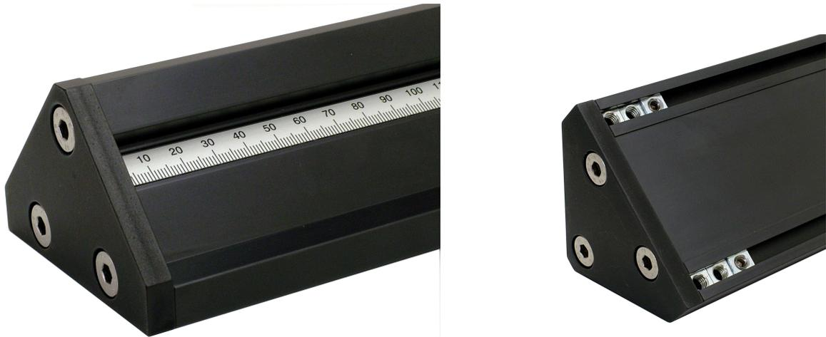
**Fig. 1 bancs optiques** avec graduation en millimètre et couvercle latéral. Un profil en aluminium anodisé en noir avec une échelle anodisée argentée/en noir Trois trous taraudés (M8) de chaque côté permettent une fixation stable de l'articulation pivotante 650 226 par exemple. Une rainure en T se trouve sur la partie inférieure avec des écrous pour la fixation des pieds et de la plaque de liaison **650 301** (rigidité en flexion réduite, utiliser les pieds 650 249).
