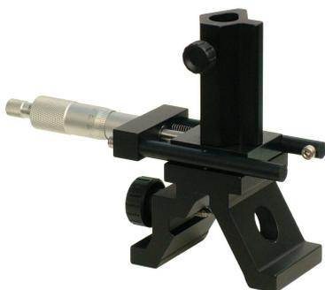
**Fig. 6: 650 293 Support amovible LB** avec une étendue de déplacement de  $\pm 12$  mm,  $H_s = 90$  mm,  $B = 50$  mm. Réglage au moyen d'un micromètre. Jeu entre la plaque de glissement et les arbres de guidage: environ 50  $\mu$ m.
