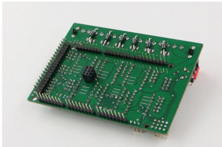
7. Freilaufdioden von der Rückseite aus einstecken und auch von der Rückseite anlöten. Achtung: Evtl. etwas von „falschen“ Kontakten wegbiegen.
