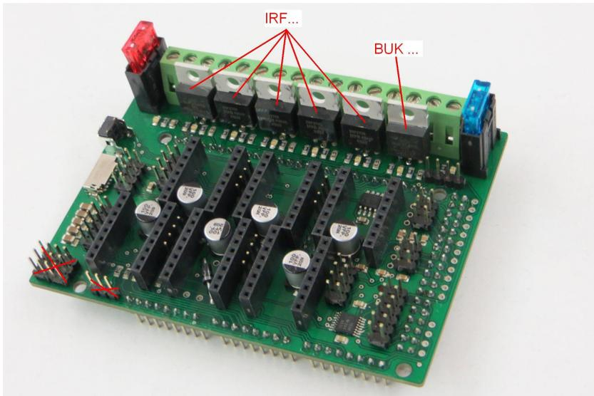
1. Alle oberen Stiftleisten außer 1x12 (am rechten Rand) einlöten. Falls die 4x3 Stifte (AUX-Servos) unten links montiert werden, diese rückseitig kürzen (Arduino-Spannungsversorgung steht sehr hoch).
