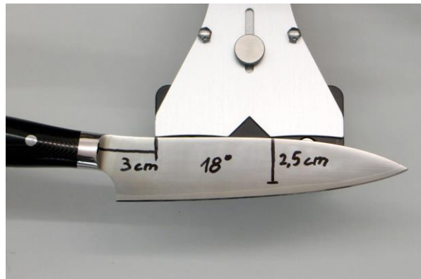
Abb. 5: Foto zur Dokumentation der Einstellungen. Die 2,5 cm geben den Abstand der Anschlagplatte zur Vorderkante der Messerauflage an.
