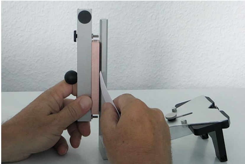
Abb. 8: Mittels 4 Papierstreifen (0,1 mm pro Streifen bei Kopierpapier mit 80 g/m 2 ) wird an der Sechskantstange des Gerätes gemessen, wie hohlgeschliffen ein Schleifstein ist.
