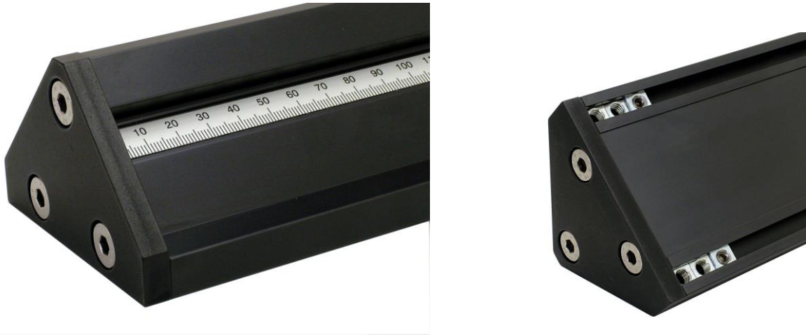
Abb. 1: Optische Bänke mit Millimeterskala und seitlichen Abdeckplatten. Schwarz eloxiertes Aluminiumprofil mit silber/schwarz eloxierter Skala. Jeweils 3 seitliche Gewindebohrungen (M8) ermöglichen die stabile Montage von z. B. dem Drehgelenk 650 226. An der Unterseite befindet sich eine T-Nut mit Muttern zur Montage der FüÙe und der Verbindungsplatte 650 301 (verringerte Biegesteifigkeit, zur Nivellierung FüÙe 650 249 verwenden).
