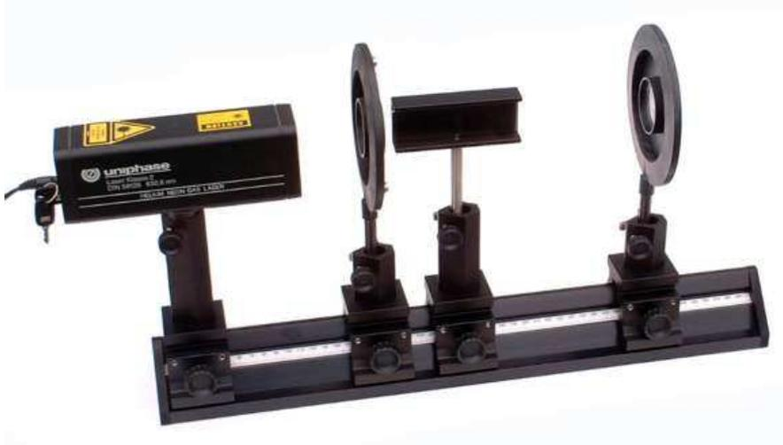
Fig. 4 : Montage « Expérience d'interférence classique ». Position des composants (bord gauche du coulisseau optique) : laser : 0 mm, lentille  $f = 5$  mm : 150 mm, miroir de Fresnel : 220 mm, lentille  $f = 200$  mm (uniquement montée si l'on mesure l'écart entre les sources lumineuses virtuelles) : env. 380 mm. L'image d'interférence est obtenue sur un écran (ou un mur clair) à 2-3 m de distance.
