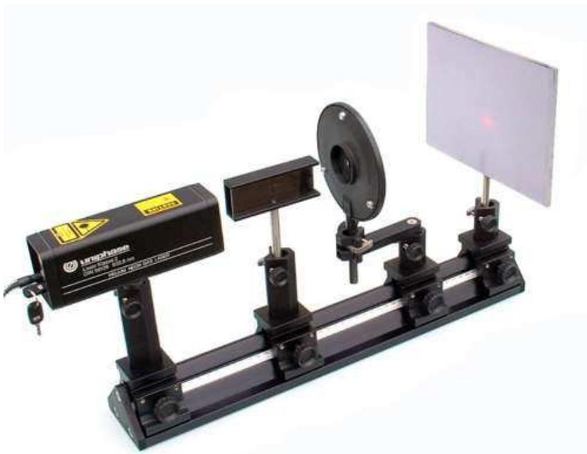
Fig. 3 : Montage « Expérience d'interférence compacte »
